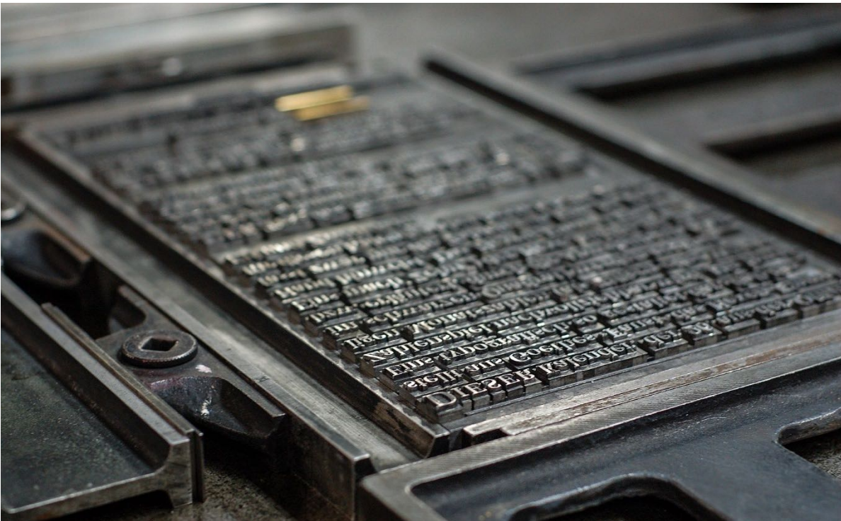
Abbildung 1: «Druckform in einer Druckmaschine»; (c) Ralf Roletschek / roletschek.at, GFDL 1.2 https://de.wikipedia.org/wiki/Bleisatz#/media/Datei:2009-04-18-noerdlingen-rr-05.jpg [30.3.2022]
